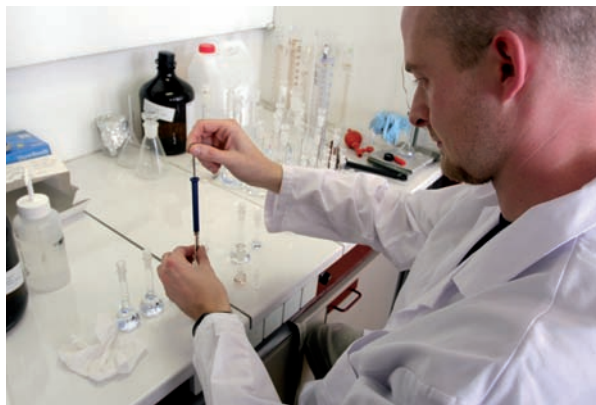
Préparation des standards de calibration d'analyse des COV (composés organiques volatiles).
