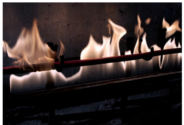
Essais de résistance au feu d'un câble électrique).
