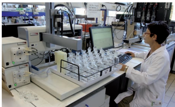
Mesure de la DBO 5 (demande biologique en oxygène).
