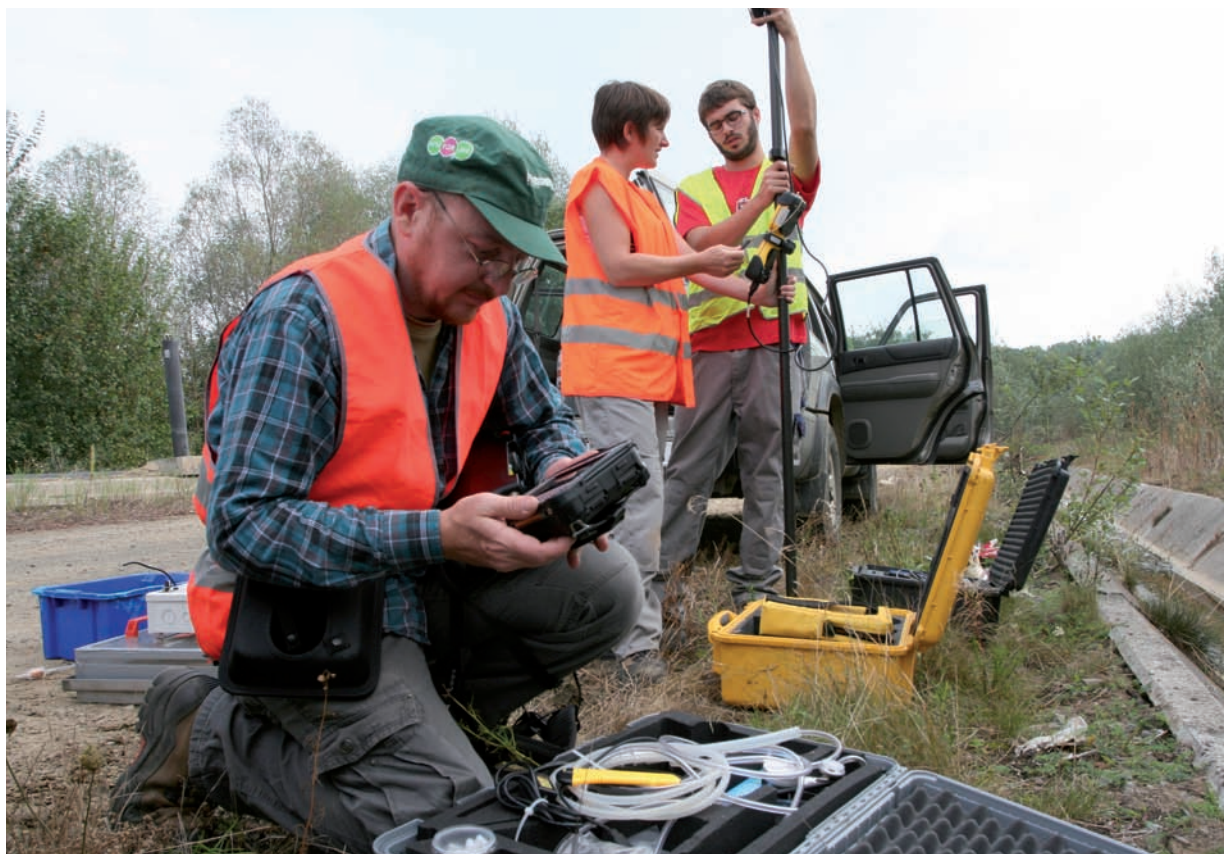
Mesure d'émission surfacique (méthane) à Mont-Saint-Guibert.
