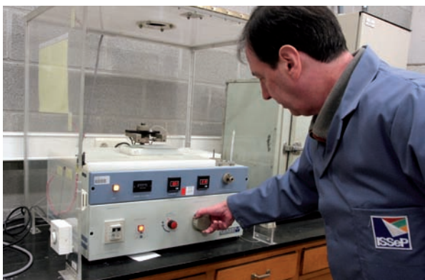
Essai indice de résistance au cheminement.
