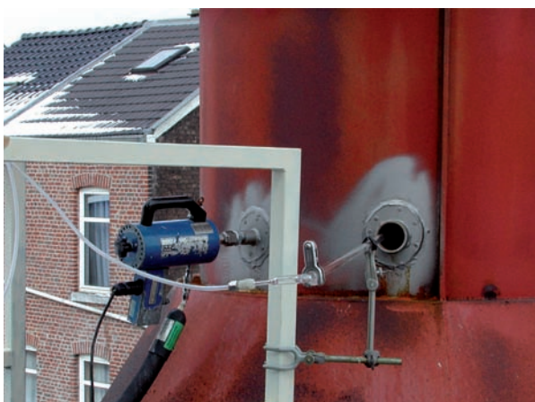
Echantillonnage des gaz majeurs – système de condensation.
