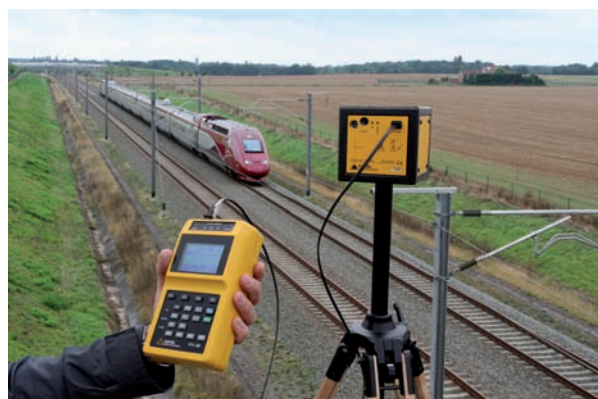
Mesure du champ électromagnétique à proximité d'une voie ferrée.
