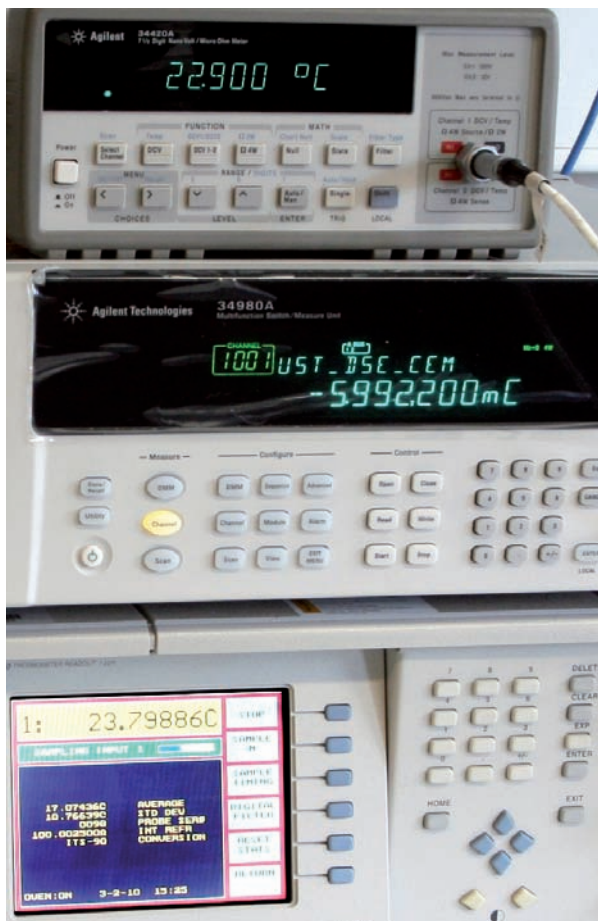
Etalonnage de sondes de température.
