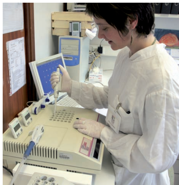
Test d'inhibition bioluminescence Vibrio fischeri .
