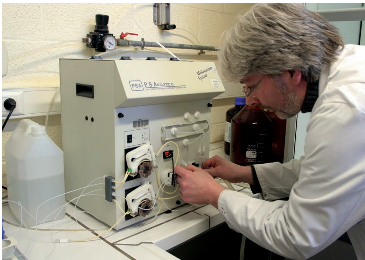
Analyse, par fluorescence atomique, du mercure dans des échantillons des réseaux pluies.
