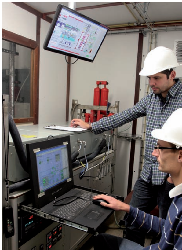
Analyse on-line des gaz non condensables produits par gazéification.
