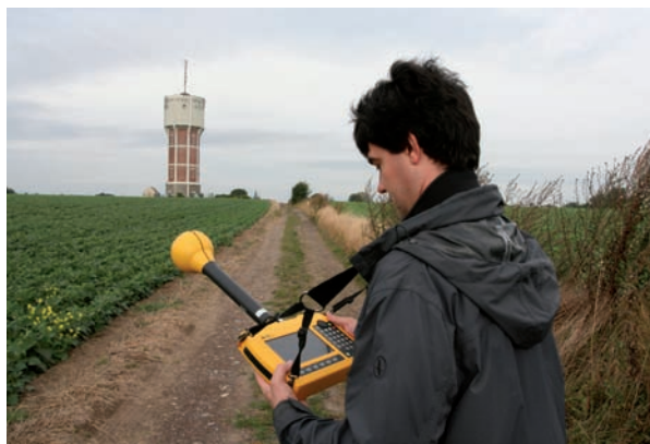
Mesure du champ électromagnétique rayonné par des antennes de téléphonie mobile.
