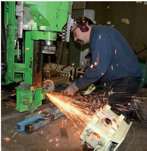
Meulage pour transformation d'une pièce de manutention.
