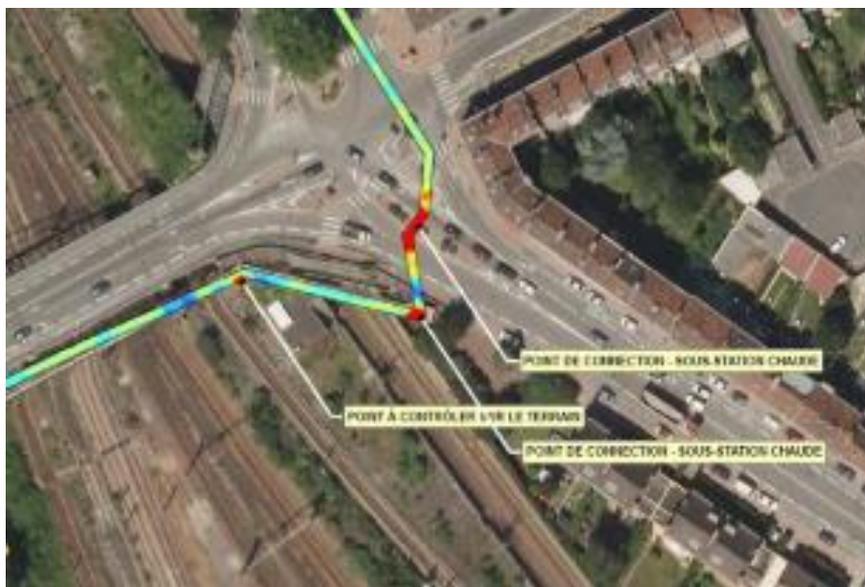
Détection des fuites dans les réseaux de chauffage urbain
