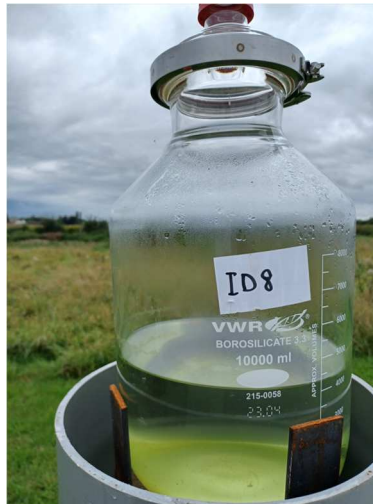
Figure 1. Dispositif de récolte des retombées atmosphérique au moment de la relève après 28 jours sur le terrain
