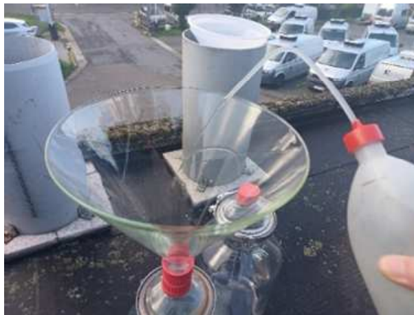
Figure 3. Rinçage de l'entonnoir lors de la relève
