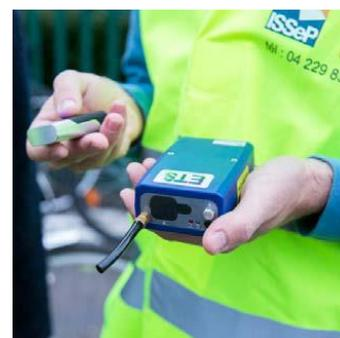
Analyseurs Black Carbon et traceur GPS utilisés par les cyclistes pour le projet ExTraCar
