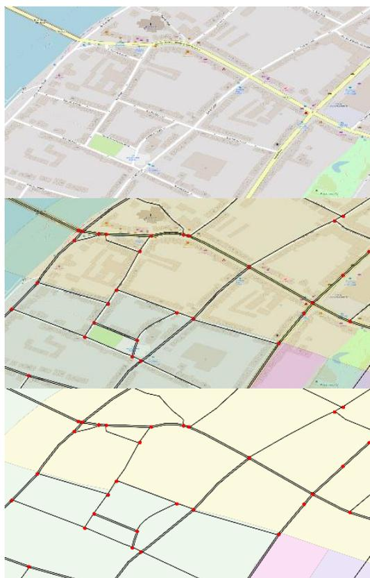
**FIGURE 29. PASSAGE DU RÉSEAU ROUTIER PHYSIQUE AU MODÈLE DE RÉSEAU.**
