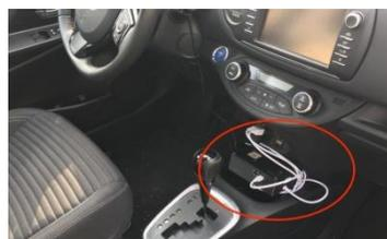
Boîtier diagnostic installé dans le véhicule
