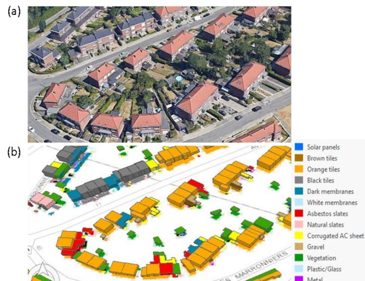
Figure 2. Exemple de cartographie 3D des matériaux de toitures dominants (Source : CASMATTELE 1).
