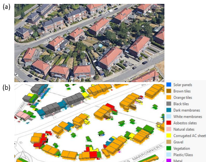
Comparaison entre (a) une image haute résolution issues de Google Earth, et (b) une représentation en LOD1 des matériaux de toitures dominants identifiés par bâtiment .
