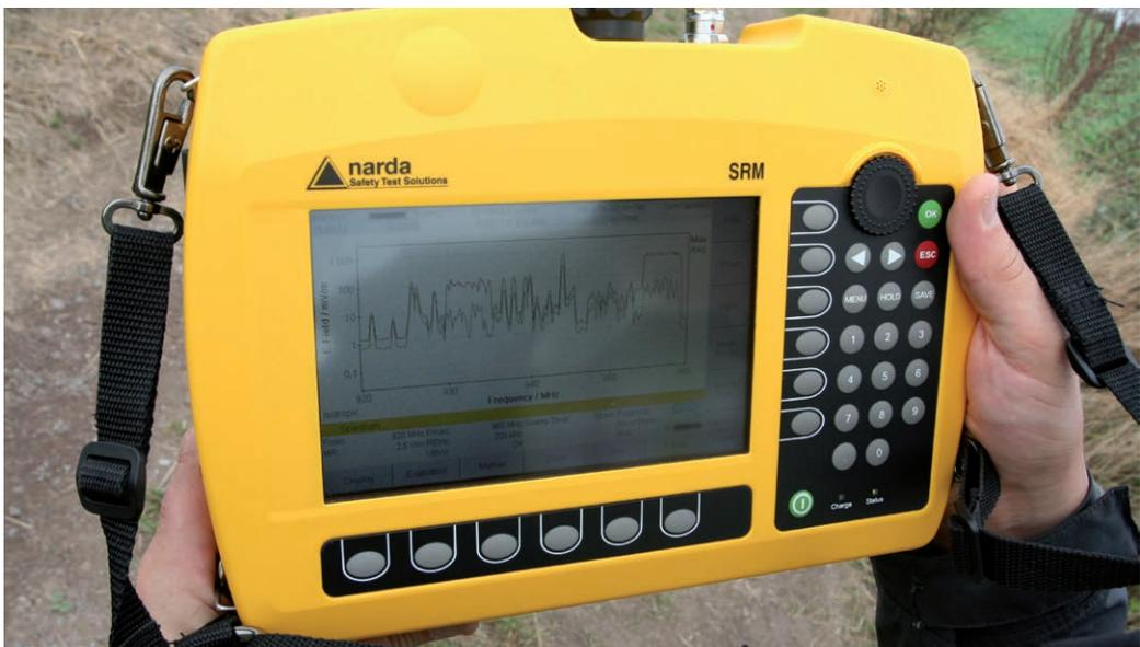
Contrôle des antennes-relais de téléphonie mobile, mesures sélectives du champ électromagnétique (photo ISSeP)
