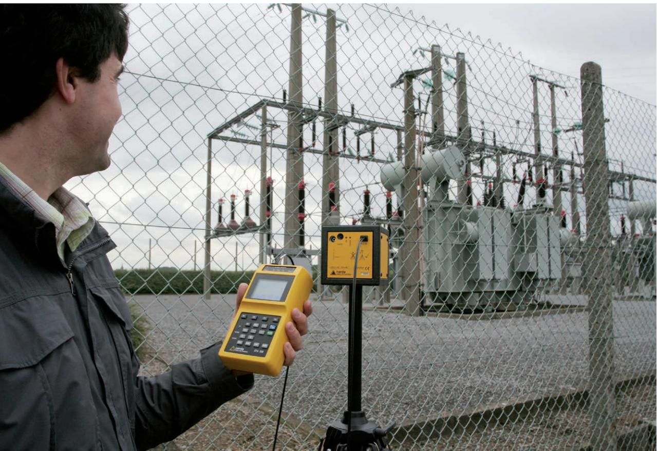
Mesures du champ électrique et du champ magnétique basse fréquence produits par un poste haute tension (photo ISSeP)
