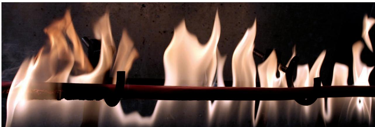
Essais de résistance au feu d'un câble électrique (photo ISSeP)
