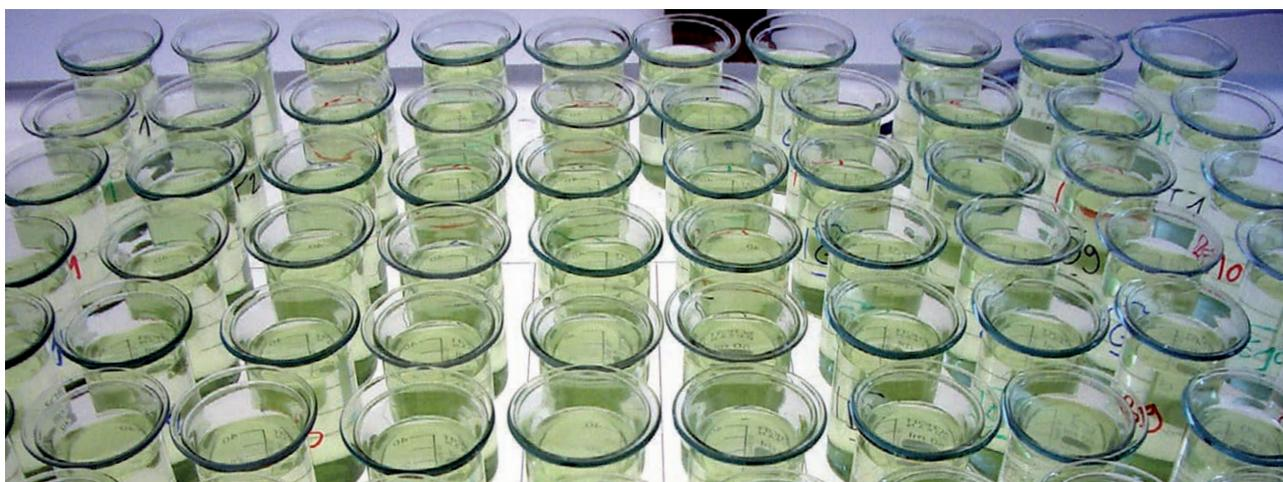
Mise en œuvre du YES test, Yeast Estrogen Screen Test (photo ISSeP)
