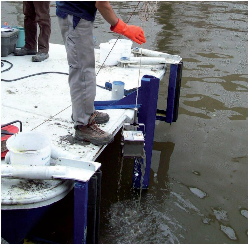
Prélèvement de sédiments dans les voies navigables (photo ISSeP)
