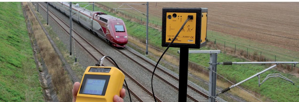
Mesures du champ électrique et du champ magnétique basse fréquence produits par une ligne TGV (photo ISSeP)
