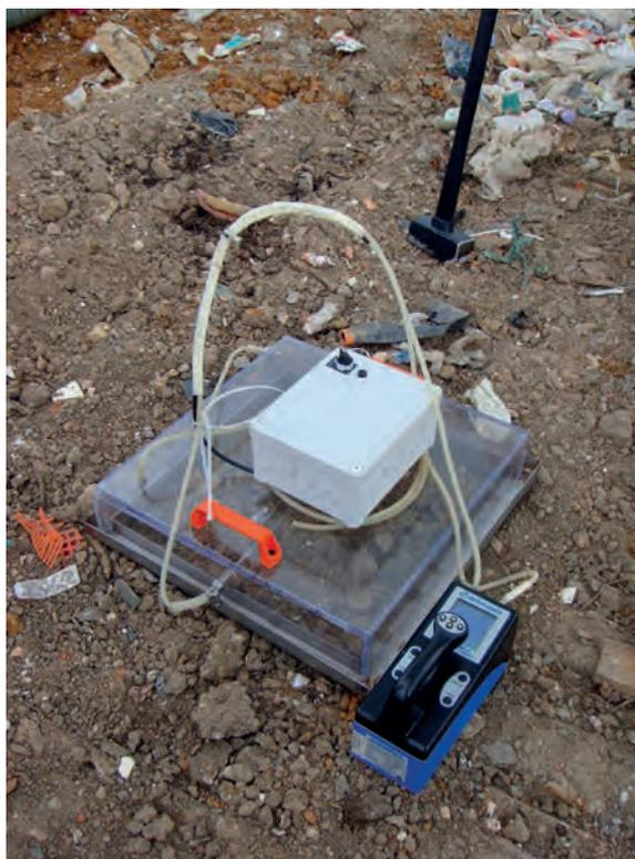
Dispositif de mesure des flux diffusifs de biogaz sur un C.E.T.
