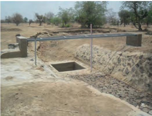
Dispositif de mesure des débits et de la charge de fond
