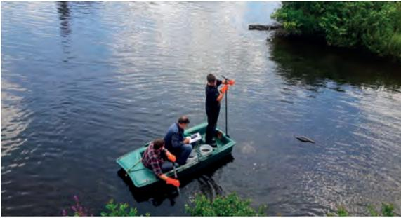
Prélèvement de sédiment dans l'ancien canal de l'Ourthe à Chênée
