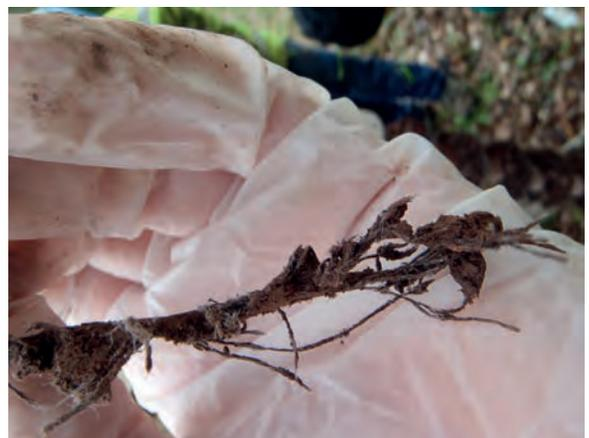
Joint amiante remonté lors d'un forage du sol
