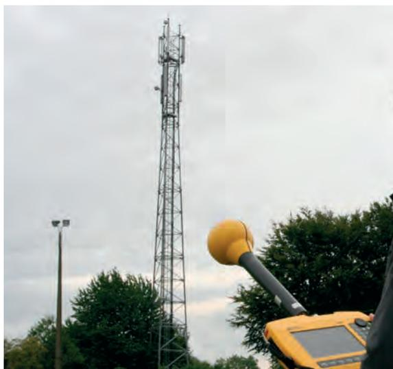
Mesure du champ électromagnétique généré par des antennes-relais de téléphonie mobile
