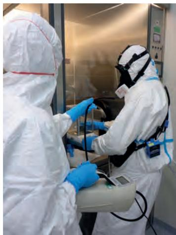
Mesure de l'exposition de l'opérateur au laboratoire au cours d'un essai d'explosivité du noir de carbone
