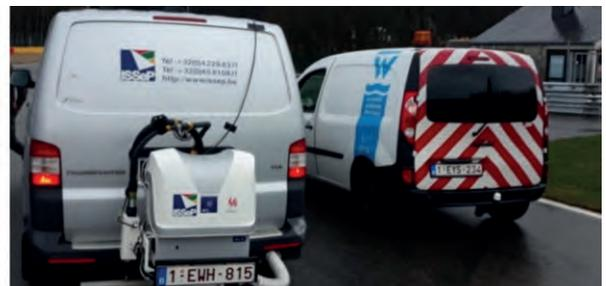
Essais de mesure des émissions à l'aide d'un PEMS
