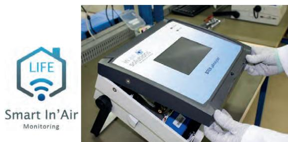
Prototype d'analyseur pour la mesure des BTEX
