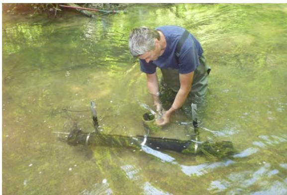
Récolte de MES dans le Hoyoux à l'aide d'un dispositif de prélèvement intégrateur
