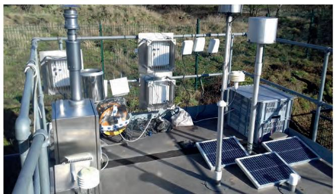
Prototype Saiga (à gauche) – Comparatif de divers instruments low-cost utilisés pour la mesure de PM2.5 mené à la station d'Angleur (à droite)
