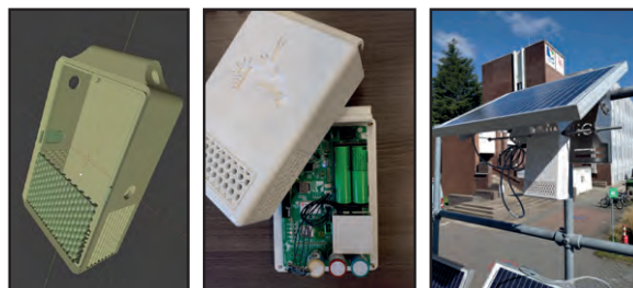
Figure 2 - Modèle du boîtier réalisé sous Blender (à gauche), boîtier imprimé en 3D avec le circuit imprimé inséré (au centre), ministration installée sur le toit de la station Val Benoît (à droite).
