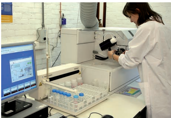
ICP-MS pour analyse de métaux lourds dans la fraction PM 10 de la matière particulaire en suspension selon la norme NBN EN 14902.
