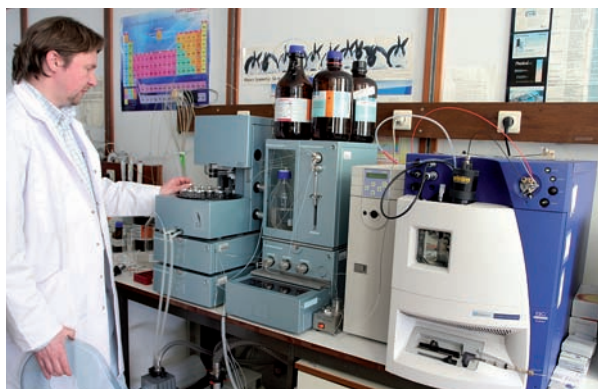
Dosage de pesticides au moyen d'une méthode utilisant une extraction en phase solide (SPE) suivie d'une chromatographie en phase liquide couplée à la spectrométrie de masse en tandem (LC/MS-MS).
