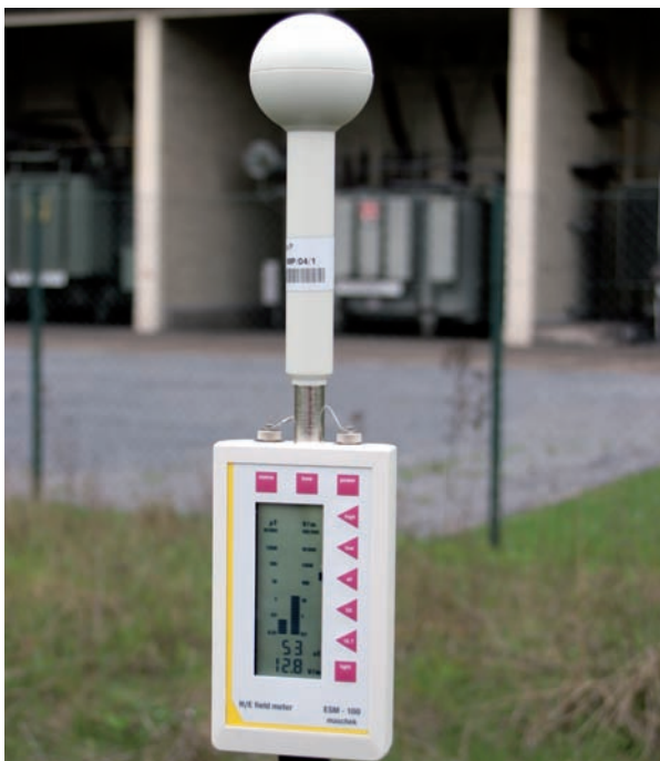
Mesure des champs électriques et magnétiques générés par une ligne à haute tension.
