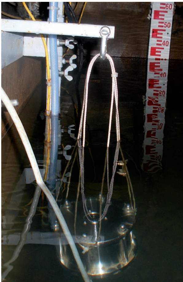
Résurgence de la Grotte du Chalet (commune d'Aywaille) – Mesure du débit, pH, conductivité, fluorescence.
