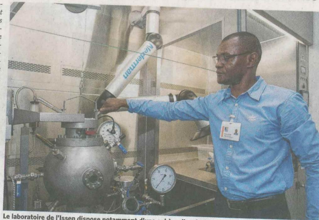
Le laboratoire de l'Issep dispose notamment d'une sphère d'explosion pour tester l'explosivité des nanoparticules. © AVPRESS.
