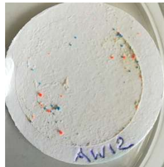
FIGURE 21 : FILTRE OBTENU APRÈS LE PROTOCOLE DE SÉPARATION DES MPs DANS UN EFFLUENT
