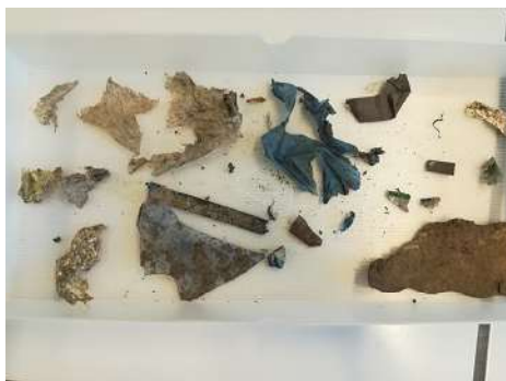
FIGURE 40 : CONTAMINANTS RETROUVÉS DANS LA TERRE UTILISÉE DANS LES BACS POTAGER
