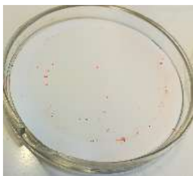
FIGURE 13 : FILTRE OBTENU LORS DU PROTOCOLE APPLIQUÉ SUR UNE EAU DE SURFACE
