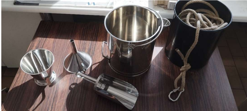
FIGURE 31 : MATÉRIEL DE PRÉLÈVEMENT, COMPOSÉ DE GAUCHE À DROITE D'UNE CRUCHE, D'UN ENTONNOIR, D'UNE PETITE PELLE, D'UN SCEAU EN INOX ET D'UNE CORDE EN CHANVRE NATUREL
