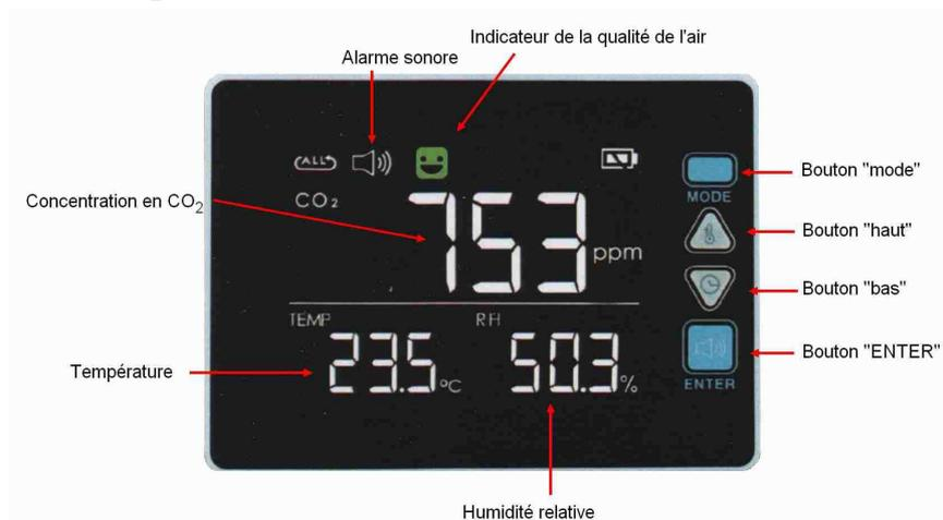
Le capteur permet de mesurer, en continu, la concentration en CO<sub>2</sub> (de 0 à 5000ppm), la température (de 0°C à 50°C) et l'humidité relative (de 0 à 100 %).
