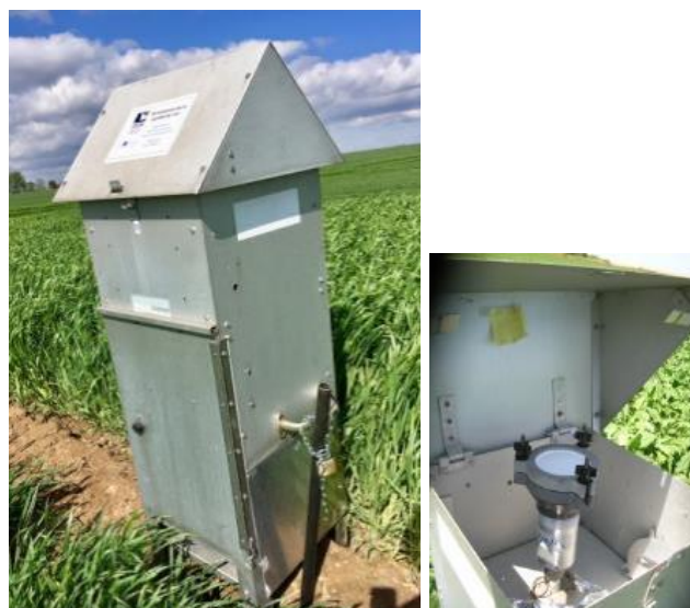
Figure 2.3 (a & b): Echantillonneur d'air & Tête de prélèvement (Capteur actif 'Air')
