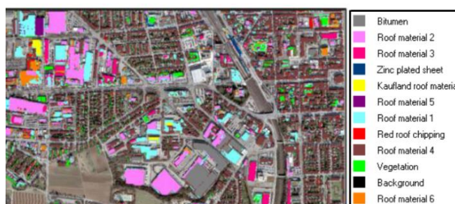
Exemple d'une classification des toitures réalisée à Ludwigsburg (Allemagne). Image extraite de Chisense (2012).
