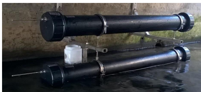
Echantillonneur intégrateur développé dans le cadre du projet GiSseD
