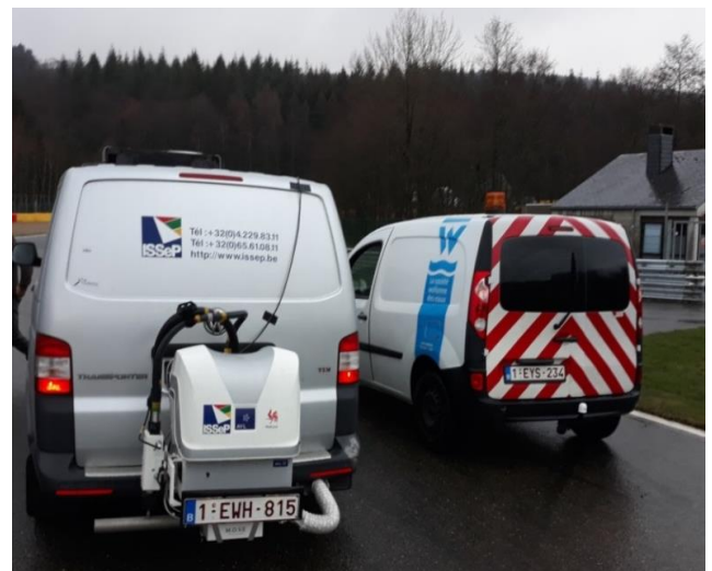
Mesure des émissions d'un véhicule en conditions réelles de roulage
