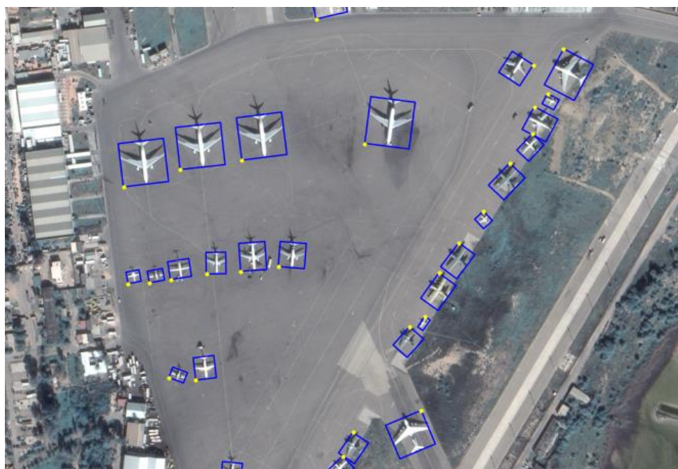
Annotation des avions sur une image Pléiades de l’aéroport de Mitiga (Libye).
