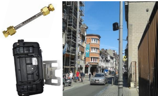
Tube passif et radar de comptage de trafic.
