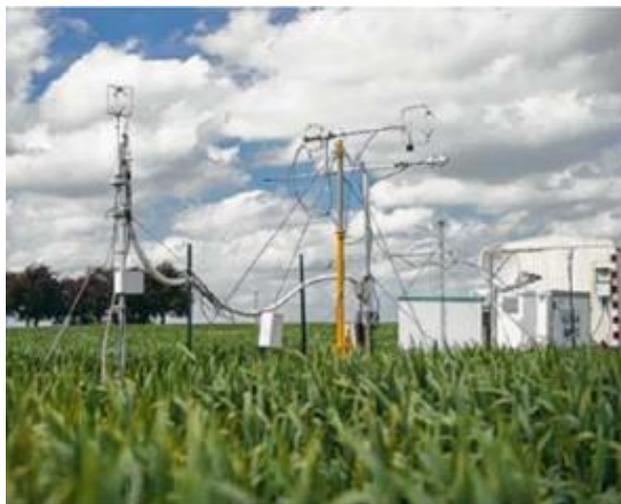
Mesure des flux de CO<sub>2</sub> et étude du rôle limitant sur le réchauffement climatique joué par la végétation
