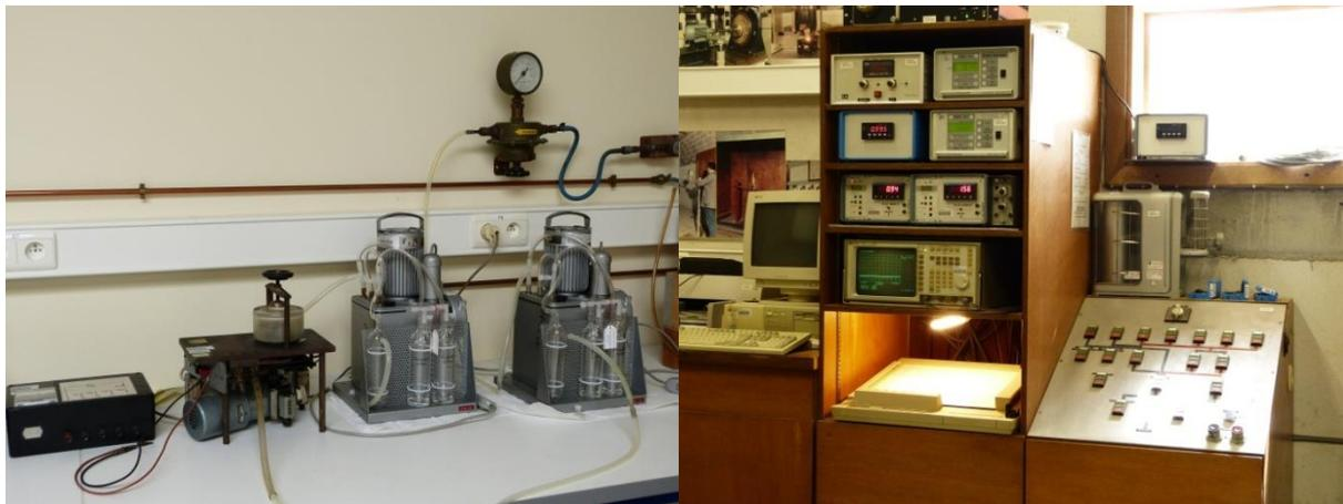
*A gauche : banc d'essai à l'éclateur normalisé (norme EN/CEI 60079-11 : sécurité intrinsèque)*
