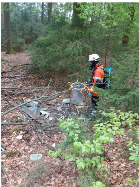
*(A1-6) Prélèvement d'air ambiant sur une zone de dépôt sauvage de déchets*
