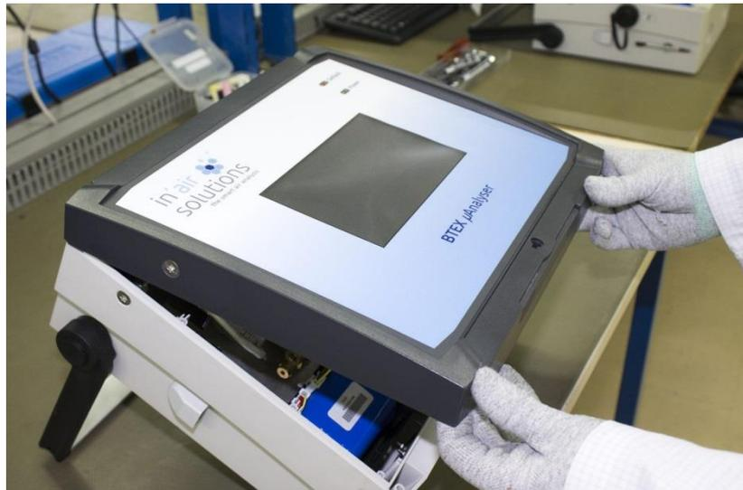
*Prototype d'analyseur pour la mesure des BTEX*
