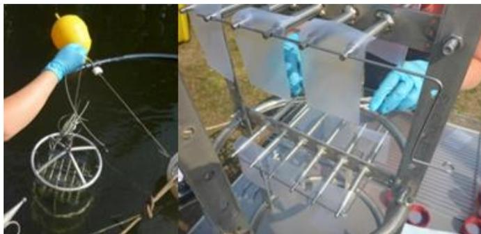
*Déploiement d'échantillonneurs passifs de type silicone rubber (SSP-M823) sur la Meuse à Visé*
