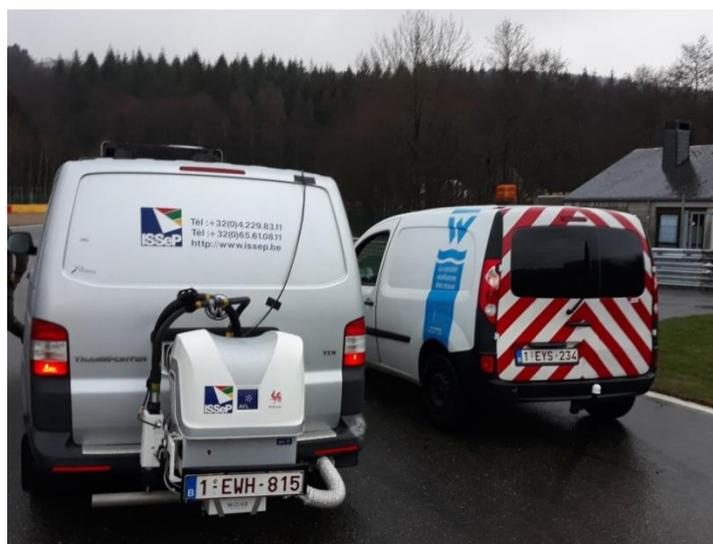
(A1-1) Le PEMS monté sur un véhicule lors d'essais en conditions réelles de roulage
