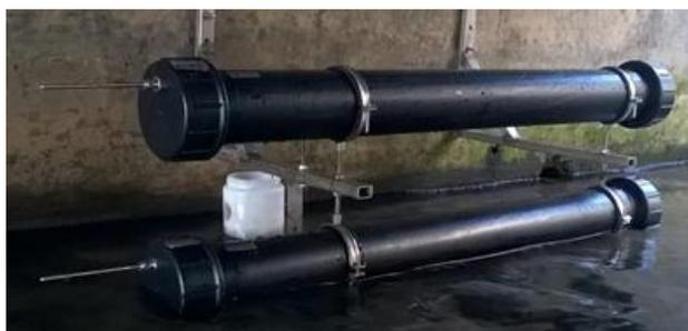
*Prototype de Time Integrated Sampler développé dans le cadre du projet GISSeD*
