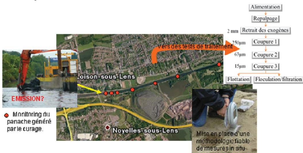
Figure 3 : Schéma représentant les actions mises en place lors de l'opération menée sur le canal de Lens.
