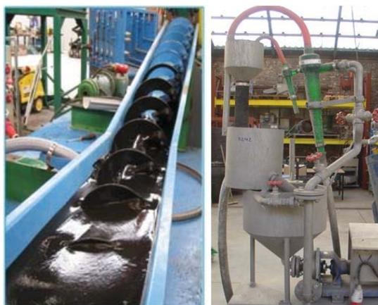
Figure 2.11 : Photos d'un classificateur à vis (séparation sable fin/limon) et d'un hydrocyclone (séparation limon/«argile»)
