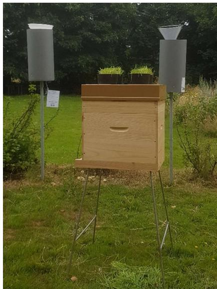
**Figure 5.** Dispositifs de prélèvement des retombées atmosphériques utilisés dans le cadre du projet Aéro-Sols (de gauche à droite : dispositif de collecte des métaux lourds, dispositif de biosurveillance et dispositif de collecte des hydrocarbures).
