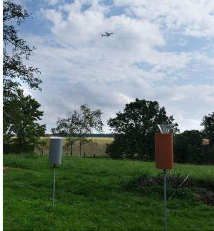
**Figure 7.** Dispositifs de récolte des retombées atmosphériques pour analyse de métaux (à gauche) et d'hydrocarbures (à droite).
