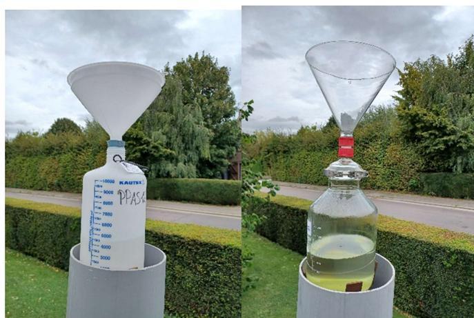
**Figure 6.** Jauge OWEN (à gauche) et jauge en verre (à droite).
