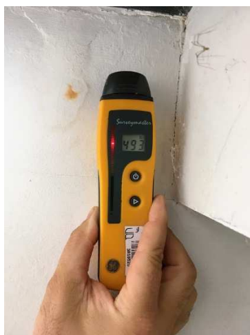
FIGURE 6. PROTOMETRE SURVEYMASTER QUI MESURE L'HUMIDITÉ DES SURFACES
