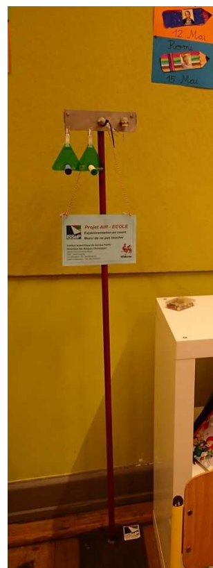
FIGURE 8. TUBES PASSIFS POUR LE PRÉLÈVEMENT D'AIR INTÉRIEUR (AU-DESSUS) ET SUPPORT COMPLET (À DROITE).
