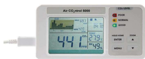
MONITEUR INSTALLÉ DANS DEUX CLASSES PAR ÉCOLE POUR SUIVRE EN CONTINU LA T°, L'HR ET LE TAUX DE CO 2
