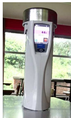
FIGURE 7. IMPACTEUR DE TYPE RCS POUR ÉVALUER LA CHARGE FONGIQUE DE L'AIR
