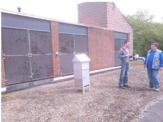
**Figure 16 :** Préleveur à la station d'échantillonnage agricole de Louvain-la-Neuve
