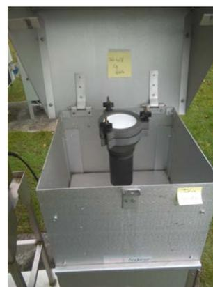
Figure 4 : Montage de la nacelle de prélèvement sur l'échantillonneur d'air
