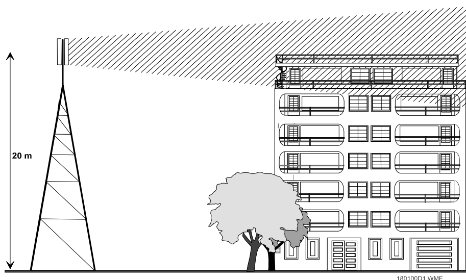
Figure 6 – Bâtiment situé dans le faisceau
