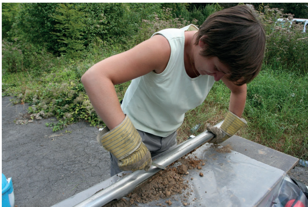
Les terres extraites par forage sont examinées puis analysées, afin de dessiner un profil du sol à différentes profondeurs
