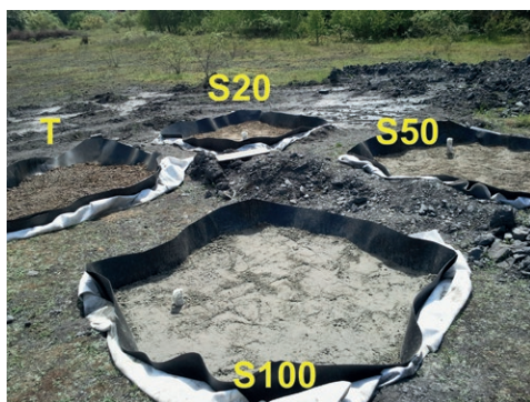
Parcelles expérimentales nouvellement mises en place et semées de ray-grass : en haut, S20 : 80% de terre agricole et 20% de sédiment ; à gauche, T : 100% de terre agricole ; à droite, S50 : 50% de terre agricole et 50% de sédiment ; en bas, S100 : 100% de sédiment
