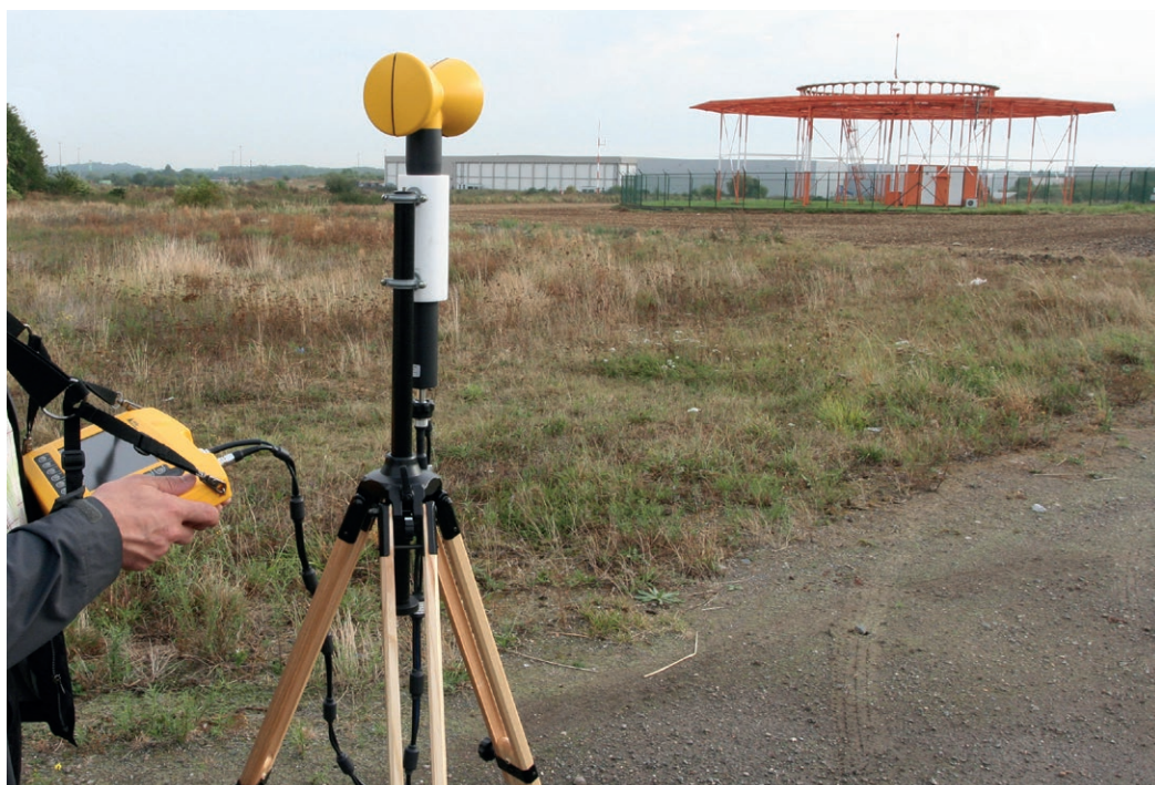
Mesure du rayonnement électromagnétique généré par une balise utilisée pour la navigation aérienne
