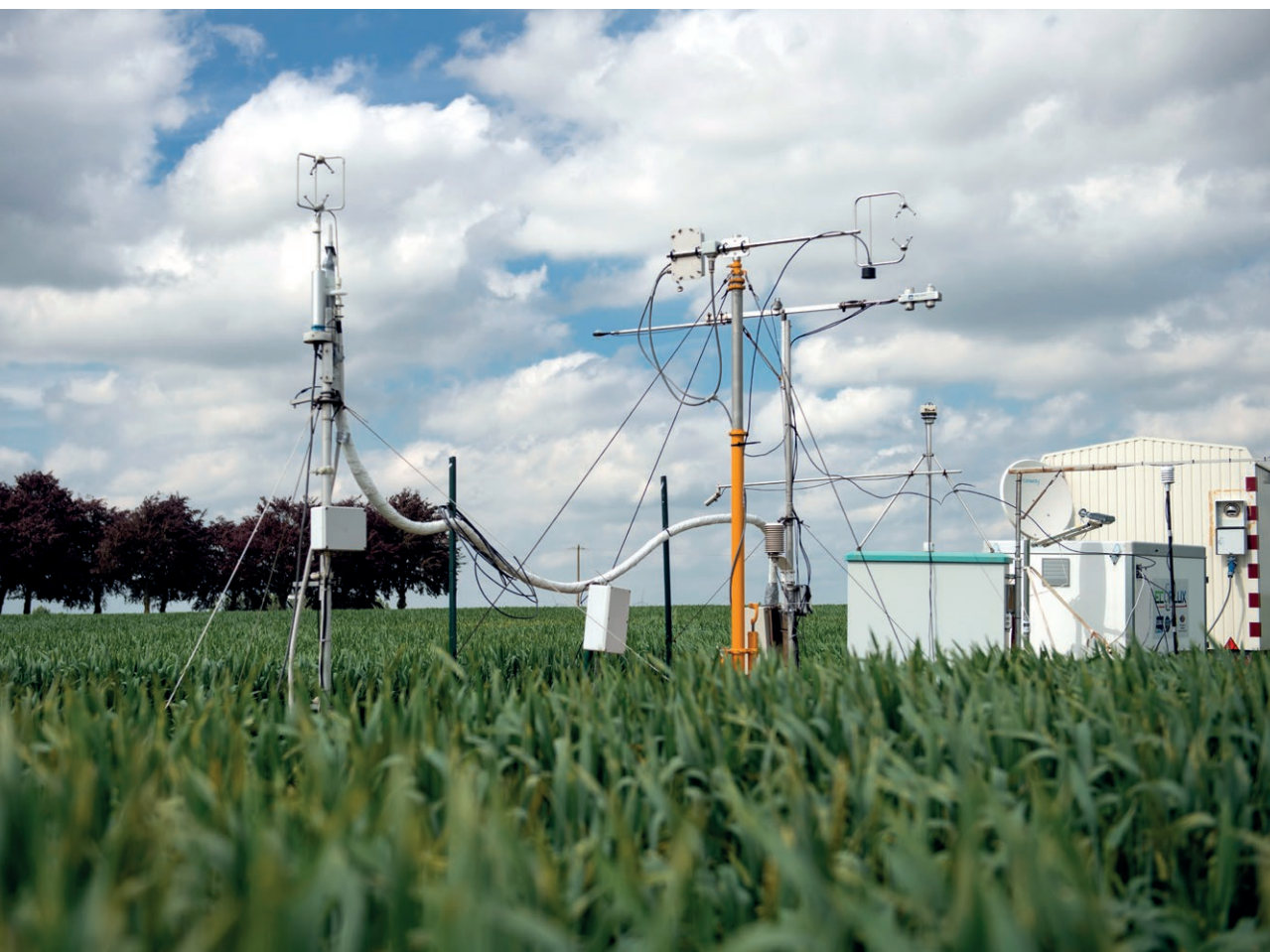
Mesure des flux de CO 2 et de l'impact de la végétation sur la lutte contre le réchauffement climatique (projet européen ICOS-WB)
