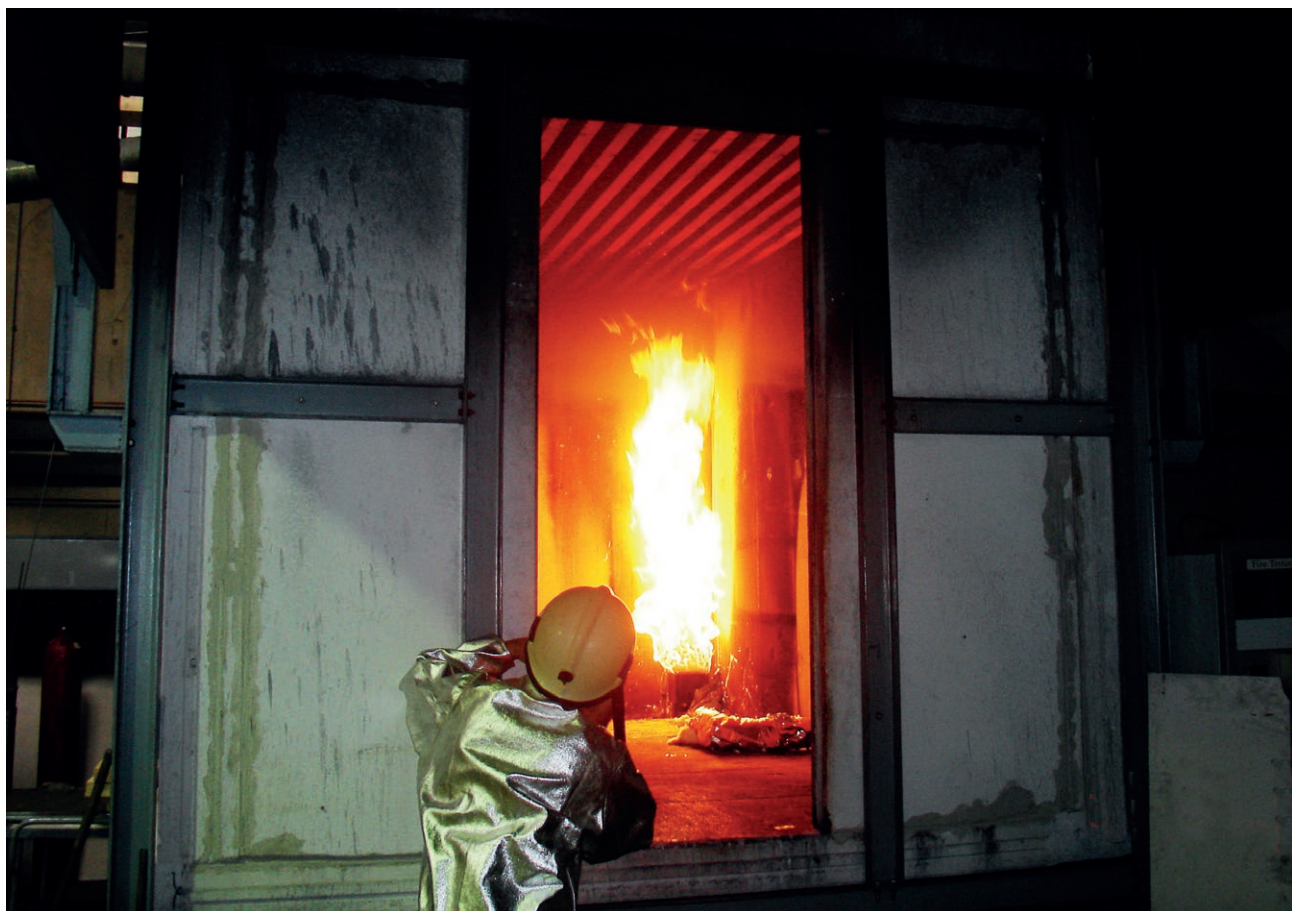
Simulation d'un foyer d'incendie dans un plafond en bois dans la Room Corner Test (RCT)
